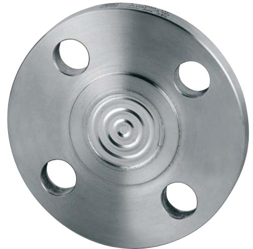
Realizzati per isolare l'elemento sensibile di manometri, pressostati, trasmettitori di pressione, da fluidi di processo corrosivi, viscosi, sedimentosi e ad alta temperatura e pressione. Una membrana saldata e sottoposta a prova di tenuta garantisce la separazione del fluido di trasmissione da quello di processo. La posizione affacciata della membrana ne permette un'accurata e approfondita pulizia.
