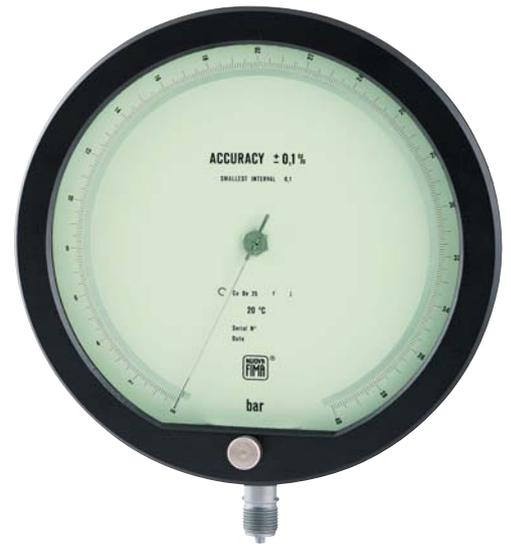
Strumenti realizzati per essere impiegati come manometri di controllo o di ricalibrazione e in altre applicazioni dove la precisione e la ripetibilità sono elementi molto importanti. I fluidi di processo devono essere liquidi o gas che non aggrediscono le leghe di rame e che non presentano una viscosità elevata e che non cristallizzano. Su richiesta sono corredati di certificati di taratura rilasciati da un laboratorio accreditato da ACCREDIA (Ex SIT: Servizio Italiano Taratura).
