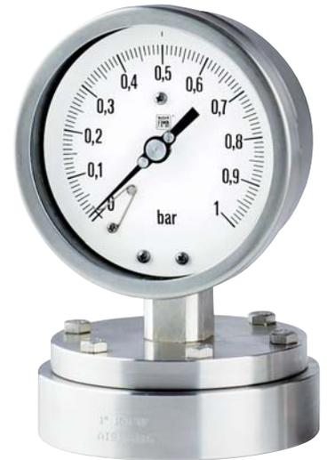
L'elemento di misura è costituito da una membrana elastica, con ondulazioni concentriche, che aziona il meccanismo amplificatore per mezzo di uno snodo. Realizzati per misurare la pressione o depressione di fluidi viscosi, sedimentosi, cristallizzabili o corrosivi. Rispetto alle molle tubolari sono più resistenti e più facili da proteggere contro le sovrappressioni e i fluidi corrosivi.
