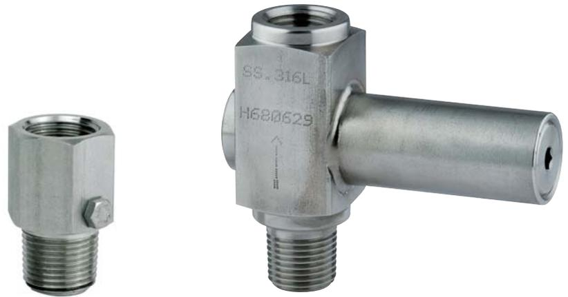
A salvaguardia di manometri e pressostati su circuiti generanti sovrappressioni elevate. Ove per cause accidentali la pressione superi il valore massimo ammesso, il limitatore esclude automaticamente dal circuito lo strumento e lo reinserisce automaticamente allorché la pressione di processo ritornerà normale. La pressione di intervento è tarabile entro un ampio intervallo.
