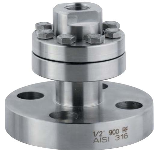
Realizzati per isolare l' elemento sensibile di manometri, pressostati, trasmettitori elettronici di pressione da fluidi di processo corrosivi, viscosi, sedimentosi e ad alta temperatura e pressione. Una membrana elastica serrata meccanicamente e sottoposta a prova di tenuta garantisce la separazione del fluido di trasmissione da quello di processo. La tenuta metallica della membrana garantisce l' utilizzo del separatore ad alte temperature eliminando i problemi delle guarnizioni.
