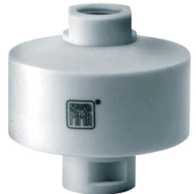
Realizzati per isolare l'elemento sensibile di manometri, pressostati e trasmettitori elettronici di pressione da fluidi di processo corrosivi, viscosi e sedimentosi. Una membrana elastica serrata meccanicamente e sottoposta a prova di tenuta garantisce la separazione del fluido di trasmissione da quello di processo. L'assenza di viti e bulloni di assemblaggio ne previene ogni tipo di corrosione. Trova impiego in impianti galvanici, trattamento acque, irrigazione, produzione schede elettroniche
