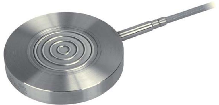
Realizzati per isolare l'elemento sensibile di trasmettitori elettronici di pressione differenziale, da fluidi di processo corrosivi, viscosi, sedimentosi e ad alta temperatura. Una membrana di separazione saldata e sottoposta a prova di tenuta garantisce la separazione dei fluidi di trasmissione e di processo. La particolare tipologia di costruzione ne garantisce una rapida e sicura pulizia. Gli attacchi sono disponibili per l'interfacciamento a flange a norme ASME e EN 1092.
