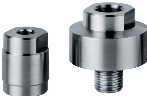
Realizzati per isolare manometri e trasmettitori di pressione da fluidi di processo corrosivi, viscosi e sedimentosi. Una membrana saldata e sottoposta a prova di tenuta garantisce la separazione del fluido di trasmissione da quello di processo. Gli attacchi filettati ne consentono l'uso in tutte quelle applicazioni dove è importante la ridotta dimensione dell'insieme e dove sono richiesti strumenti con diametro 63 mm.
