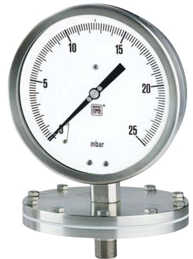
L'elemento di misura è costituito da una membrana elastica, con ondulazioni concentriche, che aziona il meccanismo amplificatore per mezzo di uno snodo. Realizzati per misurare la pressione o depressione di fluidi viscosi, sedimentosi, cristallizzabili o corrosivi. Rispetto alle molle tubolari sono più resistenti e più facili da proteggere contro le sovrappressioni e i fluidi corrosivi.
