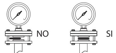
Nei modelli con attacco al processo filettato, utilizzare come presa della chiave la sede riportata sul separatore e non sul manometro: in caso contrario si potrebbe svitare lo strumento dal separatore con conseguente fuoriuscita del fluido di riempimento.
