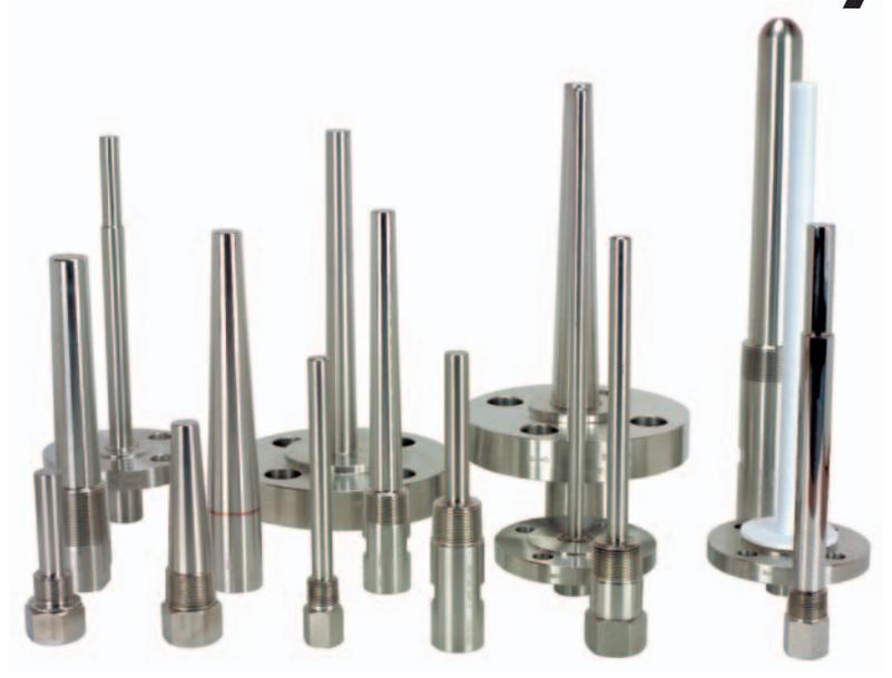
I pozzetti termometrici vengono impiegati per proteggere il bulbo da effetti corrosivi, dalla pressione, dalla alta velocità del fluido di processo e per permettere l'intercambiabilità del termometro per la ricalibrazione o la sua sostituzione, senza disturbare il pro-cesso.
