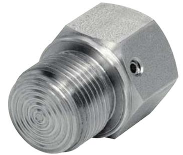
Realizzati per isolare l'elemento sensibile di manometri DN63 e trasmettitori elettronici di pressione da fluidi di processo corrosivi, viscosi, sedimentosi e ad alta temperatura. Una membrana saldata e sottoposta a prova di tenuta garantisce la separazione del fluido di trasmissione da quello di processo. La tipologia di costruzione ne consente l'uso dove è importante la ridotta dimensione e la rapidità di pulizia per frequenti manutenzioni.
